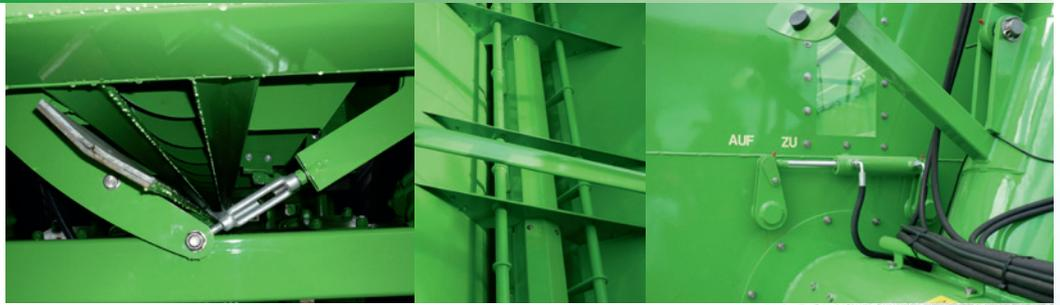
Die Restmengenentleerung bzw. Reinigung über eine manuell zu betätigende Klappe unter der waagerechten Schnecke ermöglicht ein problemloses Säubern bei Produktwechsel über die gesamte Behälterlänge. Zwei weitere große Reinigungsklappen befinden sich am Fuß der stehenden Schnecke.
